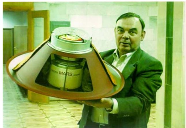
Bild 5: Modell des Micro-Mars Landegerätes im Maßstab 1:1. Mittig ist die kleine Marsstation gut zu erkennen
